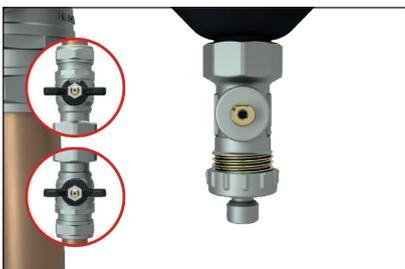
En fermant les deux robinets et en retirant l'aimant du noyau, la saleté descendra dans le séparateur de saleté. La vanne de vidange peut être ouverte et la saleté peut être collectée du séparateur. Fermez le robinet de vidange et ouvrez les robinets pour redémarrer le débit du système
